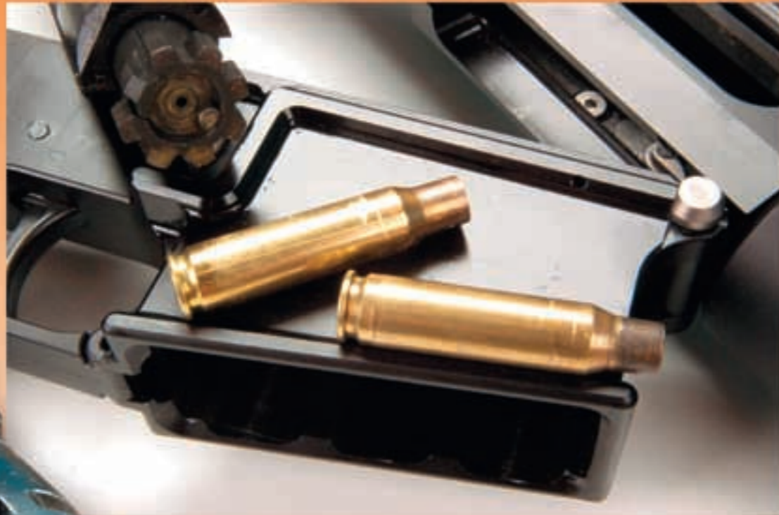
Die Hülsen kommen durch den Abweiser aus weichem Delrin-Kunststoff nahezu unbeschädigt aus dem OA-10 Sport und können ohne großen Aufwand weiterverarbeitet werden.
