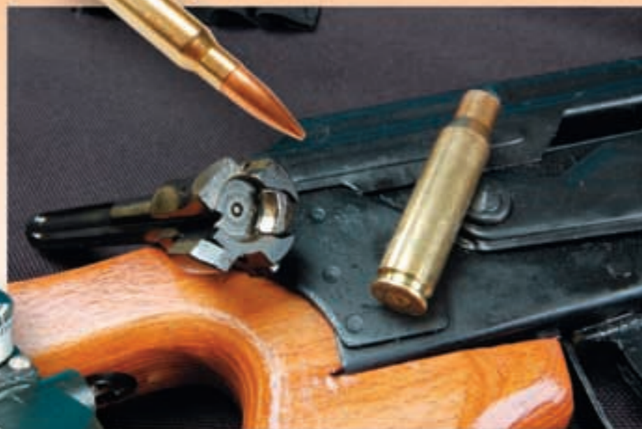
Klassische Gasdrucklader-Konstruktionen: Die typischen Drehkopfverschüsse des SSG 97 (unten) und OA-10 Sport (oben).
