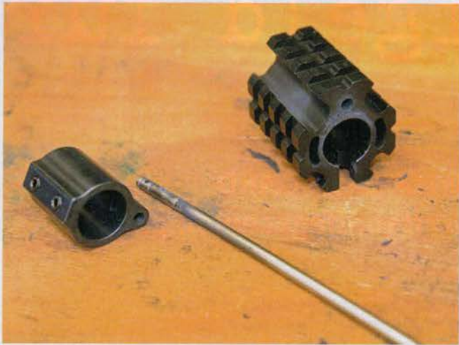
Die neue, schlanke Gasentnahme-Einheit im Vergleich zum klotzigen Picatinny-Gas-Block.
