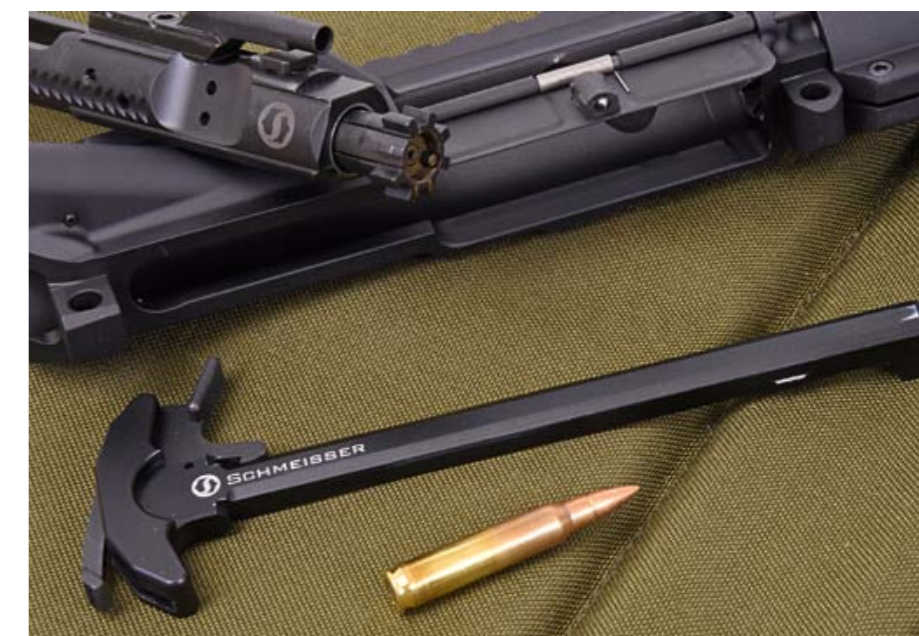
Multiwarzen-Drehkopfverschluss und Ladehebel im Detail.
