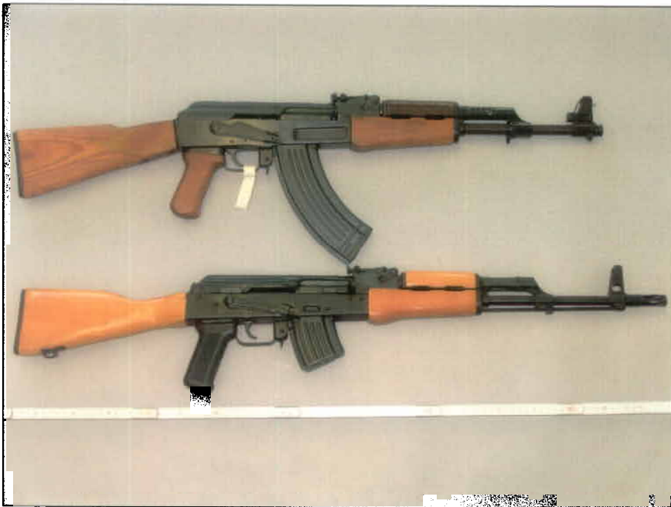
Abb. 3: Rechte Seiten-Ansichten der Originalwaffe „AK 47“ (oben) und „Cugir WS1 - 63“ (unten) beide Kal. 7,62mm x 39.
