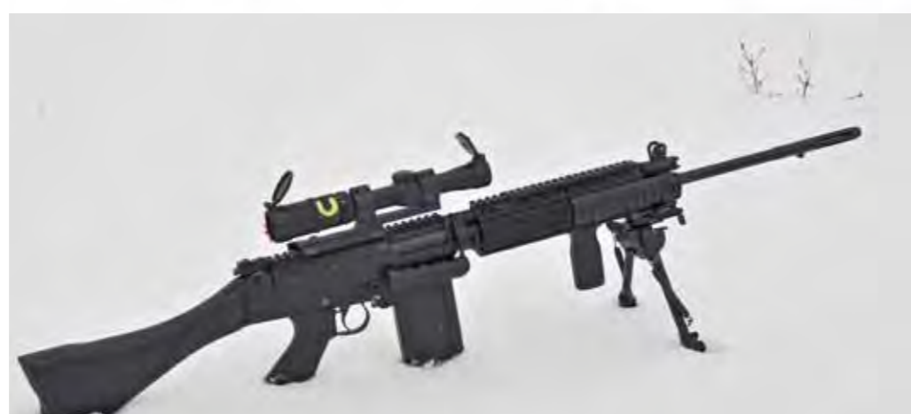
Oben, unten: Die vorgestellten Waffen sind die zivile Ausführung eines britischen SLR. Dazu wurden der Verschluss und der Lauf neu hergestellt und die Waffen verloren so ihre Kriegswaffeneigenschaft. Eigentlich gibt es keine LIAI mehr in britischen Beständen aber die Firma Waffen Schumacher hatte jedoch das Glück, dass vor einiger Zeit in einem Depot auf den Falkland-Inseln noch ca. 300 intakte Waffen entdeckt wurden. Der Kauf dieser Waffen gelang und die Firma LuxDefTec baute die Waffen durch Fertigen neuer, ziviler Verschlüsse und den Einbau von Lothar Walther-Läufen in Zivilwaffen um.
