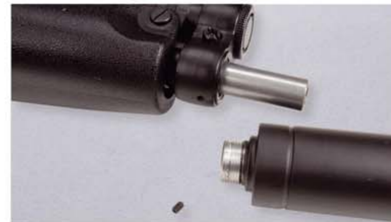
Das Element, das den Lauf umkleidet, wird zusätzlich durch eine Madenschraube gesichert.
