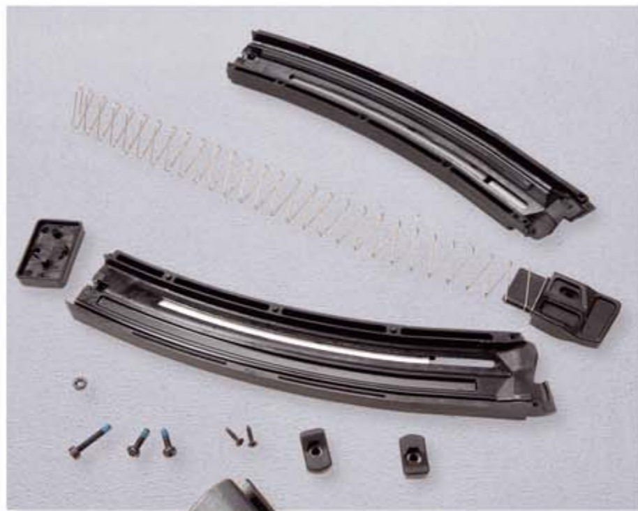
Ein kleines, patentiertes Meisterwerk ist auch das bananenförmige Stangenmagazin mit einem Fassungsvermögen von zwei, zehn oder zwanzig Patronen. Es besteht aus insgesamt 13 Bauteilen, sortiert die Patronen so, daß die Projektile leicht über Kreuz stehen und ist sehr bedienungsfreundlich.
