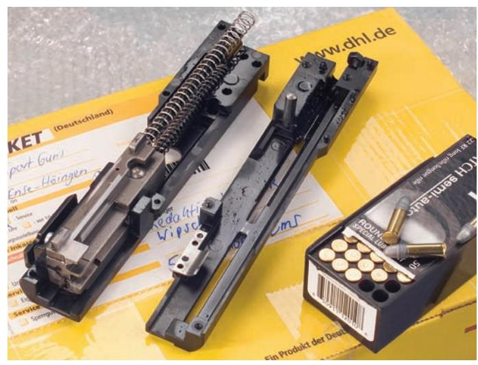
Der geöffnete (zum Reinigen nicht nötig) unverriegelte Feder-/Masse-Verschluß hat zwei Verschlußfedern (die gleichen wie in der SIG-Sauer Mosquito) und zeigte sich sauber sowie exakt gefertigt.
