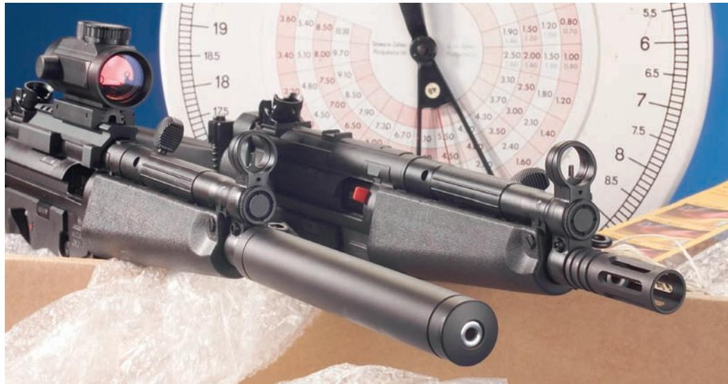
**Nur angetäuscht:** Der Lauf des GSG-5 L 1 (links) geht durch die Schalldämpferattrappe hindurch, auf dem kürzeren Rohr des A 1 sitzt ein Mündungsfeuerdämpfer. Statt der offenen Visierung kann man eine Montagebrücke für Zielhilfen aufsetzen, die sich an den vier vorstehenden Nasen rund um das Auswurffenster festklammert.
