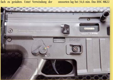
Blick auf die recht Seite des Systemkastens mit Drehhebelsicherung und Magazinauslöseknopf am Griffstück.
