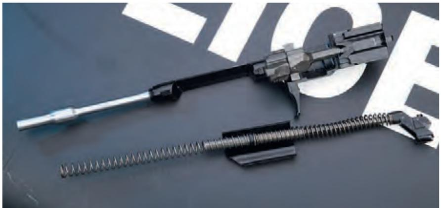
Vorn am Verschlussträger der Saiga 12 findet nicht nur der Drehkopfverschluss seine Heimat, sondern auch der beim Verriegeln nicht rotierende Stoßboden.
