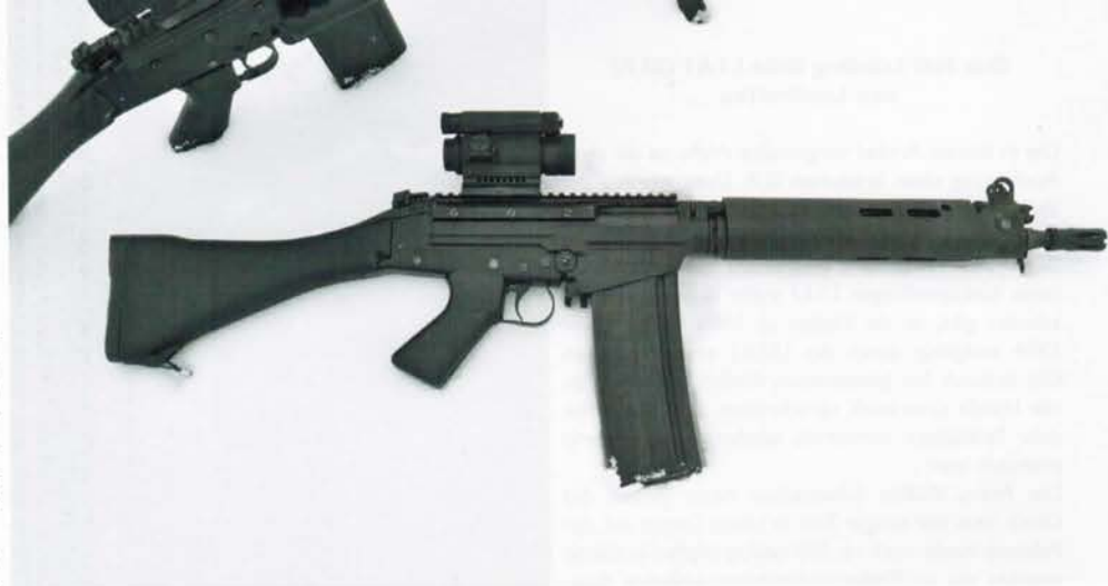
Oben, unten: Getestet haben wir sowohl das LIAI-LDT mit 55-cm-Lauf mit 1:12 Drall als auch das LIAI-LDT Compact, das als Kurzversion über einen 36-cm-Lauf verfügt. Beide Waffen wurden modernisiert.
