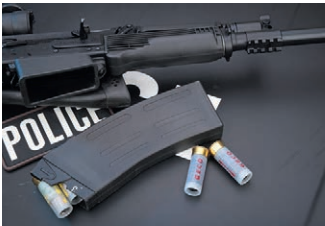
Der Magazintrichter sowie die gerade von unten einzuführenden Magazine gehören bei der Police-Version zur Grundausstattung der russischen Waffe.
