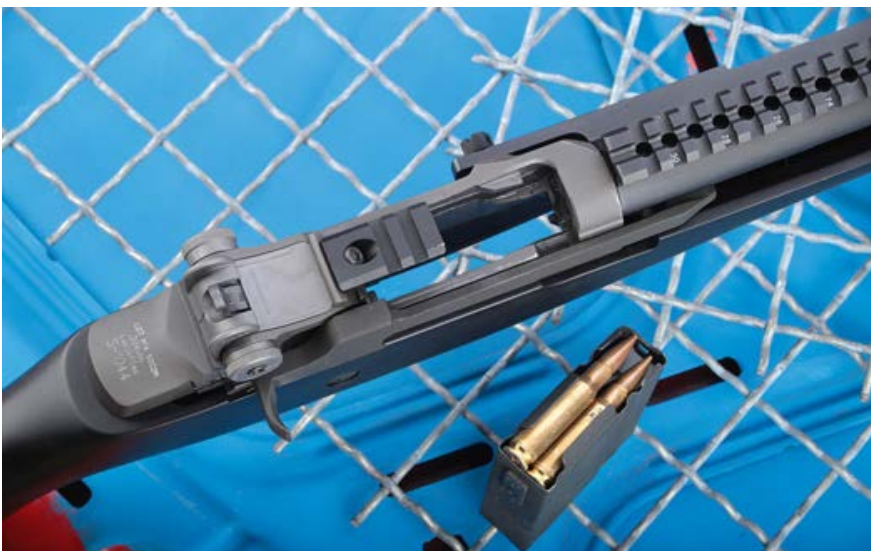
Ein kurzes Picatinny-Schienenstück vor der Lochkammer ersetzt bei dem M 14 SOCOM die Aufnahme für Ladestreifen.
